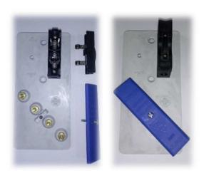
Se pueden proveer tableros de conexionado para terminales o con bornera con tabaquera porta fusible de protección, etc.
